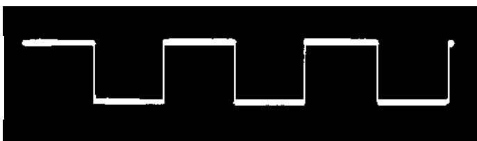
Fig. 17 TPH/U 062, TPH 055 mit Hall-IC (Motor einphasig)
