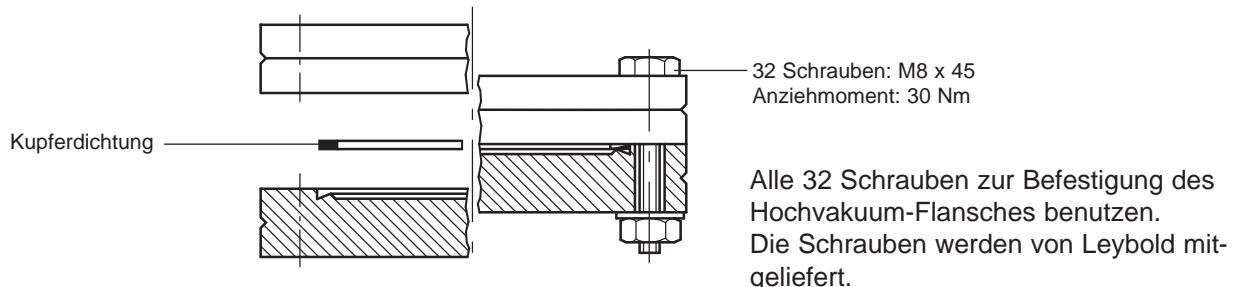
Abb. 2 Schnitt durch eine CF-Flanschverbindung
