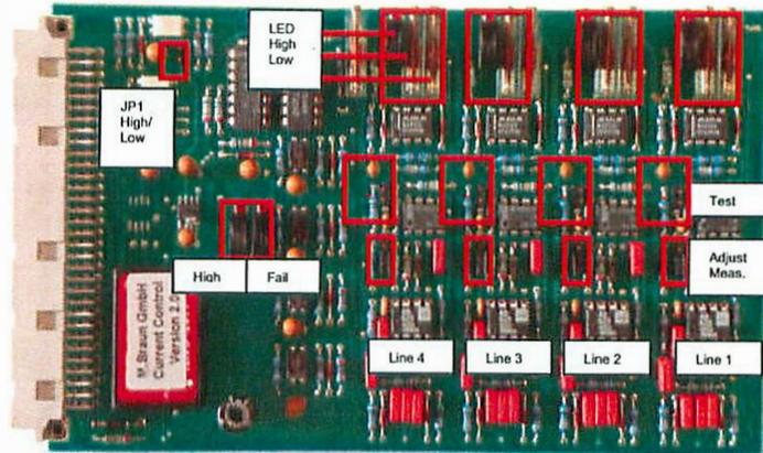
Fig. 11 : Plasma Controller PCB
