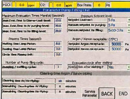
Pump filling unit parameters
